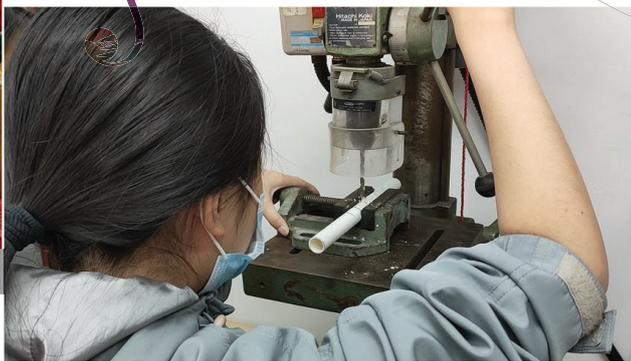
中二學生利用鑽床在學習製作牧童笛 (Recorder) 的音孔
